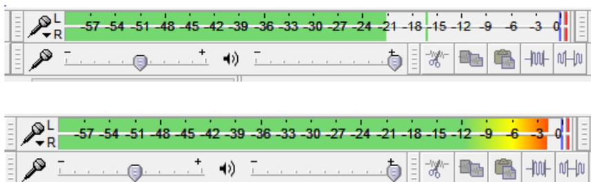
◀ Die Aussteuerungsbalken zeigen untersteuertem und übersteuertem Ton. Eine Übersteuerung liegt vor, wenn der Balken den roten Bereich erreicht.
