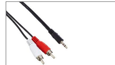
Audio-Kabel: Klinke 3,5 mm („kleine Klinke“) & 3-polig (Klinke-Stecker mit 2 „Strichen“) auf Chinch-Stecker (rot/weiß)
