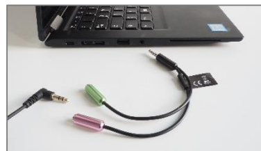
Y-Kabel: Mikrofon 4-polig (Klinke-Stecker mit 3 „Strichen“) auf Mikrofon & Kopfhörer 3-polig (Anschlüsse für Klinke-Stecker mit 2 „Strichen“)
