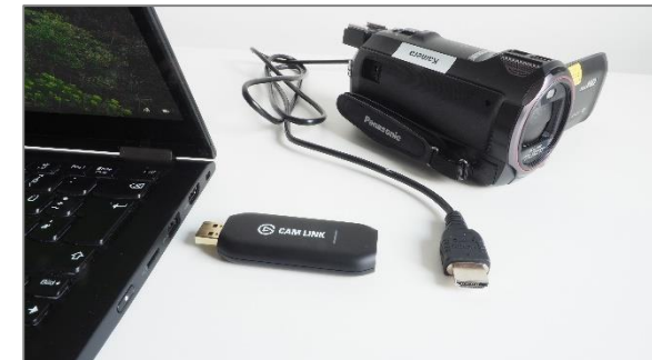
HD-Kamera mit Capture-Card (HDMI auf USB) für Anschluss an Laptop (2. Person für Kameraführung notwendig)
