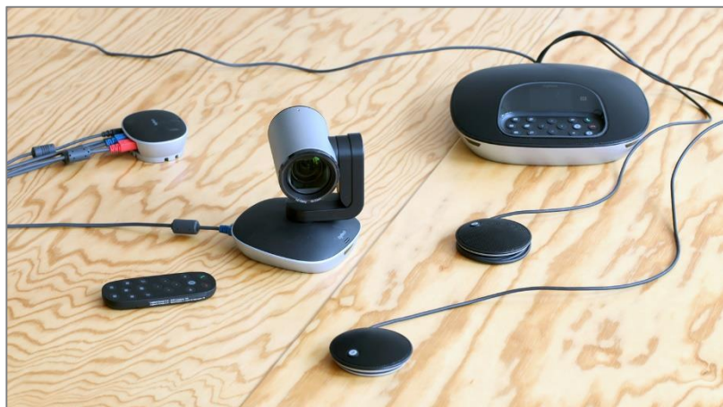
Kamera (Mitte) und Mikrofone (Rechts) werden mit USB-Hub (Links) verbunden, dieser wird per USB an den Laptop angeschlossen
