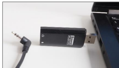
USB-Soundkarte „Soundblaster“: USB auf Mikrofon & Kopfhörer 3-polig (Anschlüsse für Klinke-Stecker mit 2 „Strichen“)
