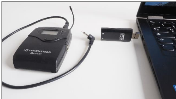
Sennheiser-Funkempfänger mit USB-Soundkarte für Anschluss an Laptop (= Audio 1 → siehe Seite 5); liegen 2 Audio-Anschlüsse am Laptop vor, kann Funkempfänger direkt per Klinke (ohne USB-Soundkarte) an Mikrofon-Eingang angeschlossen werden
