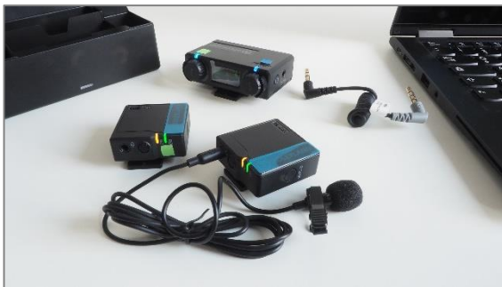
Hollyland-Funkset Duo: 2 Mikrofon-Sender (im Vordergrund) optional mit Lavalier-Ansteckmikrofon, 1 Empfänger (im Hintergrund) wird per Klinkenkabel (hier schwarz-grau) an Laptop angeschlossen; liegen 2 Audio-Anschlüsse am Laptop vor (siehe Seite 5), wird anderes Klinkenkabel (schwarz-schwarz) aus dem Set verwendet
