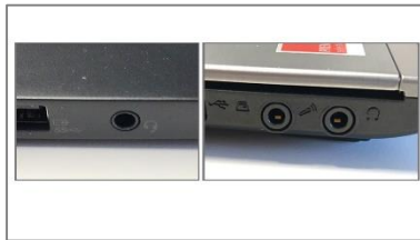
Links: Nur 1 Audio-Anschluss („Kombi-Klinke“); Rechts: 2 Audio-Anschlüsse am Laptop
