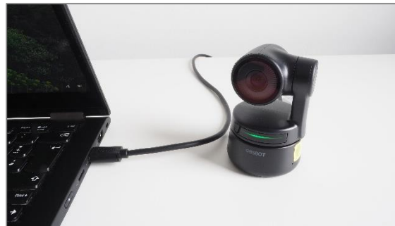
OBSbot Kamera (KI-Kamera mit Gestensteuerung für automatische Mitverfolgung einer Person & Zoomen) per USB an Laptop angeschlossen
